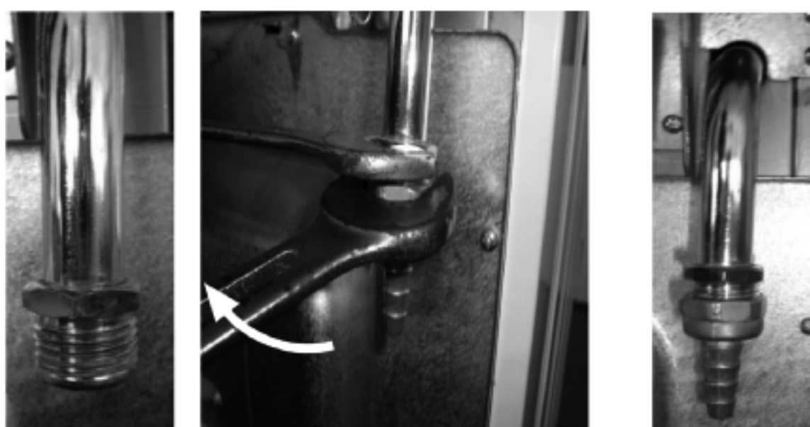
Figure 12 Montage de l'embout gaz butane
